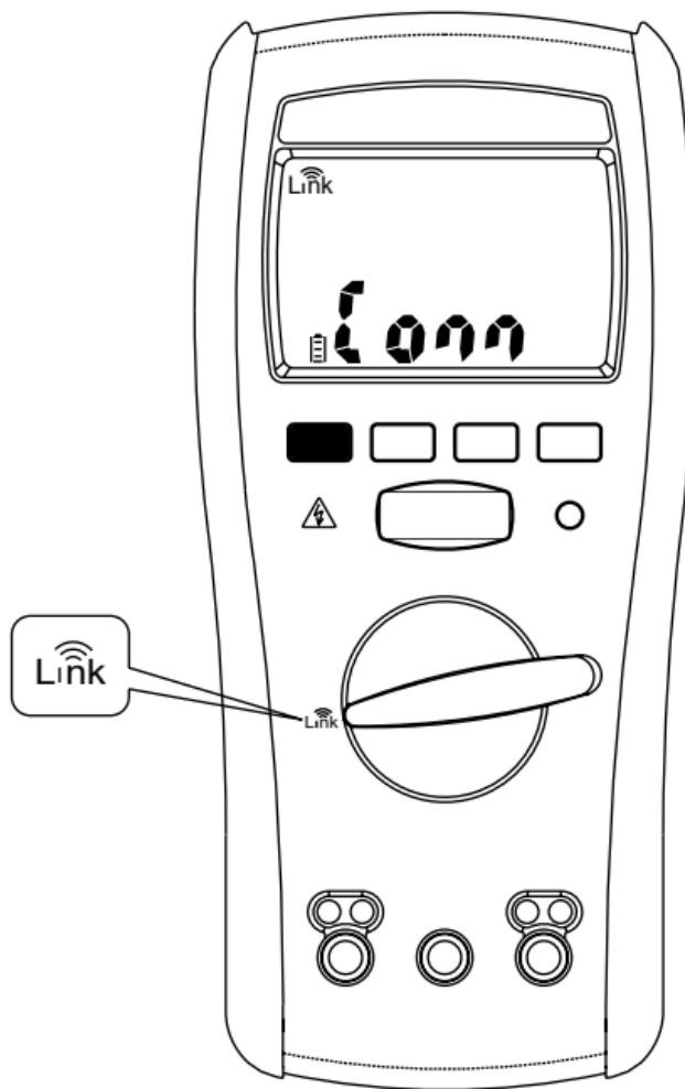
El medidor utiliza tecnología inalámbrica Bluetooth de baja energía (BLE) V5.0 para descargar los datos almacenados. El alcance de comunicación al aire libre es de hasta 6 metros. El ícono de ENLACE del medidor se mostrará permanentemente en la pantalla LCD después de que la conexión se establezca correctamente.
