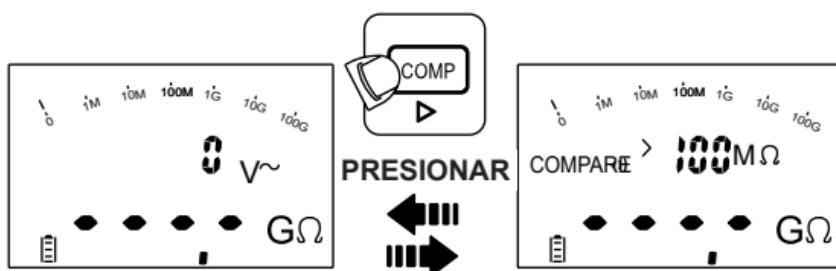
Antes de iniciar la comprobación de la resistencia de aislamiento, seleccione el valor comparativo en el modo Configuración: 0,5 MΩ, 10 MΩ, 20 MΩ, 50 MΩ, 100 MΩ, 200 MΩ, 500 MΩ, 1000 MΩ,
