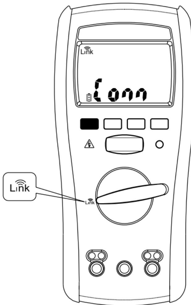
Для загрузки сохраненных данных мультиметр использует технологию маломощной беспроводной передачи Bluetooth (BLE) V5.0. Дальность связи на открытом воздухе — 6 м. После установления соединения на дисплее появится пиктограмма LINK.
