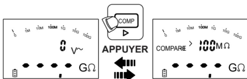
Avant de commencer le test de résistance d'isolement, sélectionnez la valeur de comparaison dans le mode Réglage : 0,5MΩ, 10MΩ, 20MΩ, 50MΩ, 100MΩ, 200MΩ, 500MΩ, 1000MΩ,
