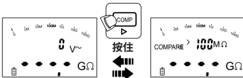
開始絕緣電阻測試前，請在設定模式中選擇對照值： $0.5M\Omega$ 、 $10M\Omega$ 、 $20M\Omega$ 、 $50M\Omega$ 、 $100M\Omega$ 、 $200M\Omega$ 、 $500M\Omega$ 、 $1000M\Omega$ 。
