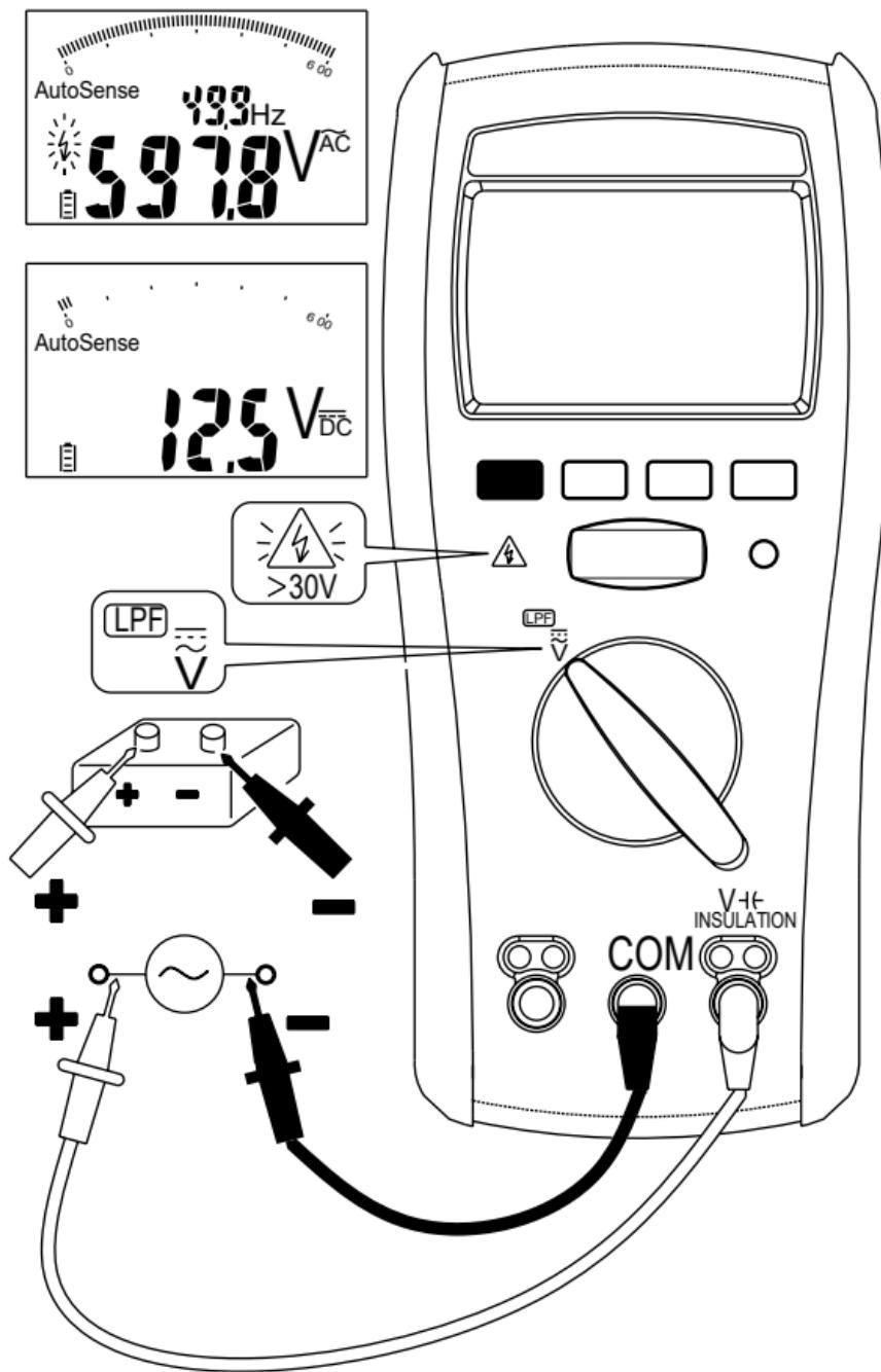
**自动感应模式：**仪表会显示 ACV 或 DCV，以较高者为准 ( $>1V$ )。若测得电压高于 660Vac/dc，萤幕会显示「 $> 660\text{Vac/dc}$ 」。
