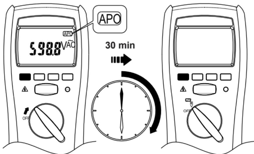
Rétablissez l'alimentation en tournant le rotateur ou en appuyant sur n'importe quel bouton.
