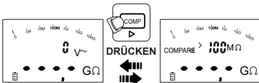
Wählen Sie den Vergleichswert im Setup-Modus, bevor Sie mit dem Testen des Isolationswiderstands beginnen: 0,5 MΩ, 10 MΩ, 20 MΩ, 50 MΩ, 100 MΩ, 200 MΩ, 500 MΩ, 1000 MΩ.
