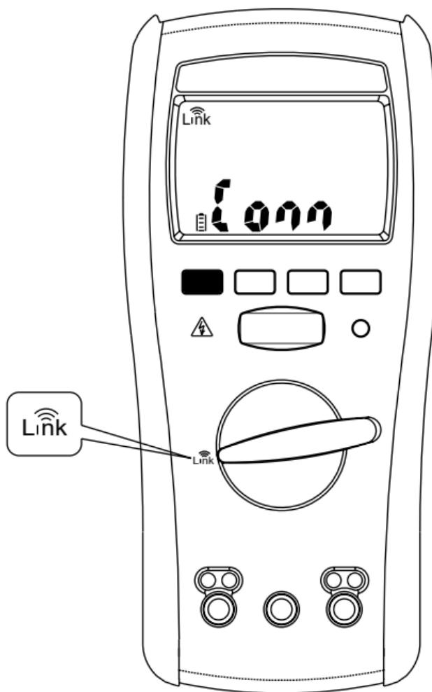
儀表使用低功率藍牙 (BLE) V5.0 無線技術傳送儲存的資料。戶外通訊範圍最高達 6m。儀表的連結圖示在成功建立連線時會在 LCD 上呈現為凍結狀態。
