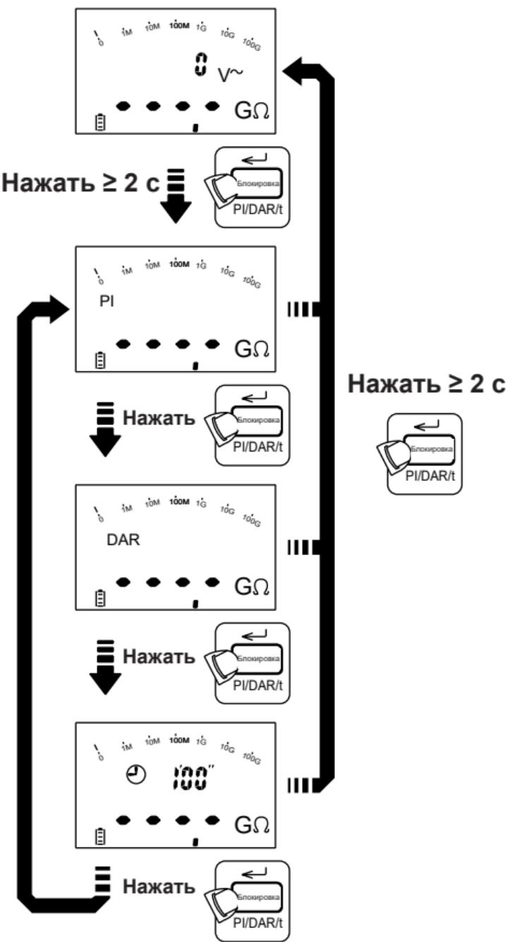
Нажмите кнопку Тест, чтобы начать/прервать измерение PI/DAR.
