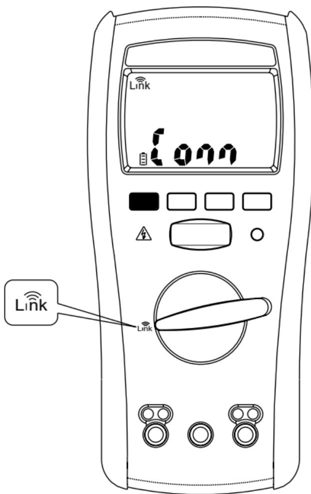
Das Prüfgerät nutzt die drahtlose Technologie Bluetooth Low Energy (BLE) V5.0, um gespeicherte Daten herunterzuladen. Der Kommunikationsbereich über die Luft liegt bei maximal 6 m. Nach Herstellung einer erfolgreichen Verbindung verbleibt das LINK-Symbol auf dem LCD-Display des Prüfgeräts.
