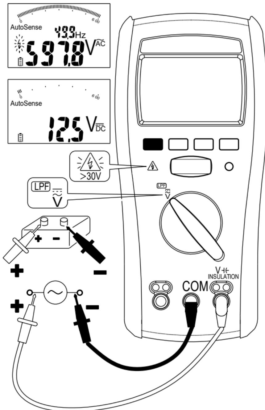
Automatischer Sensormodus Das Prüfgerät zeigt ACV oder DCV an, je nachdem, welcher Wert höher ist (> 1 V). Überschreitet die gemessene Spannung den Wert von 660 Vac/dc, erscheint „> 660Vac/dc“ auf dem Display.
