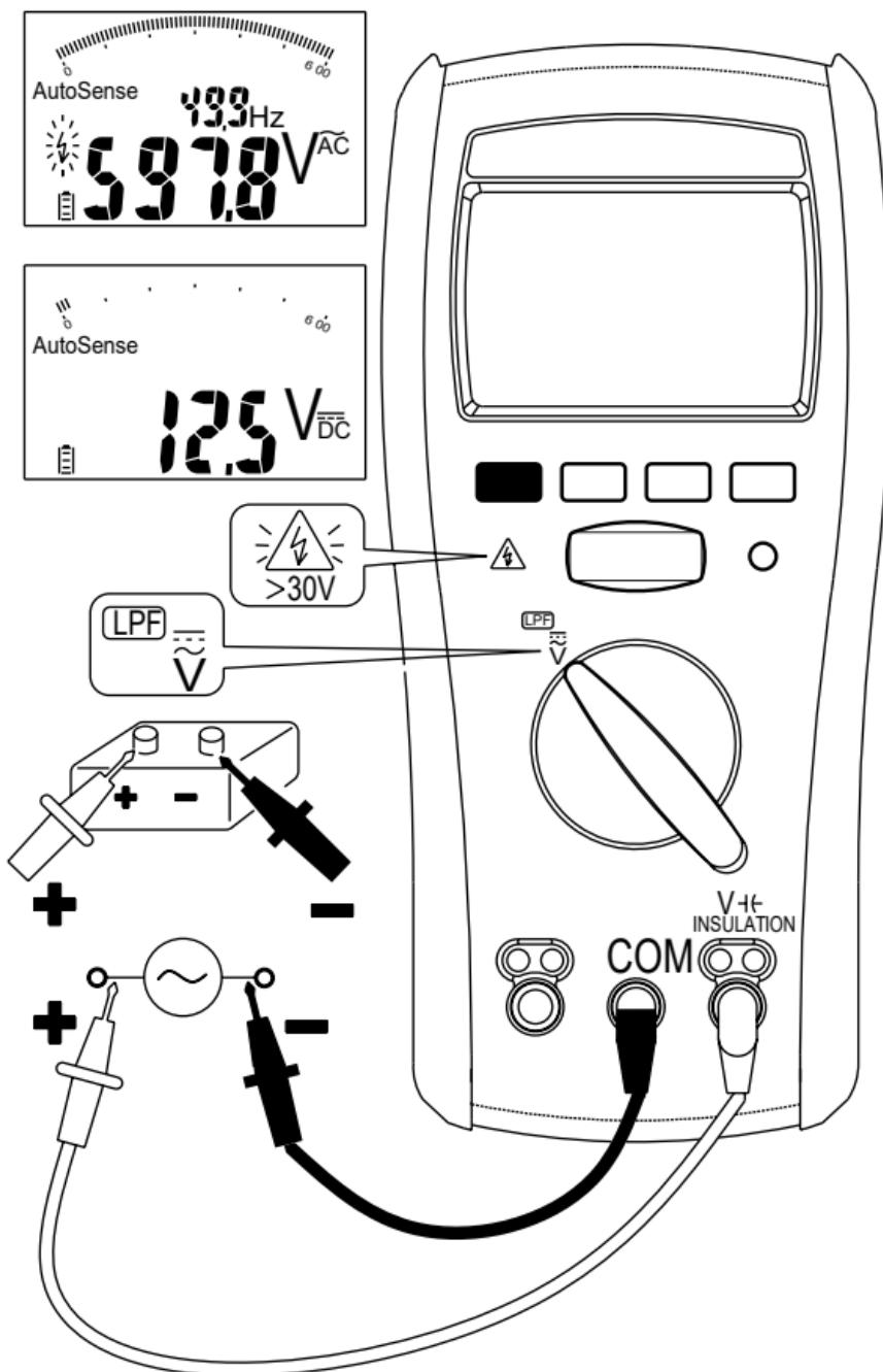
Режим автоматического определения: Мультиметр показывает ACV или DCV на основе самого большого значения (> 1 В).
