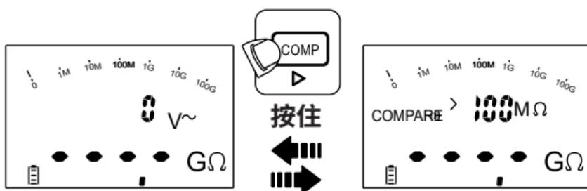
开始绝缘电阻测试前，请在设定模式中选择对照值：0.5MΩ、10MΩ、20MΩ、50MΩ、100MΩ、200MΩ、500MΩ、1000MΩ。
