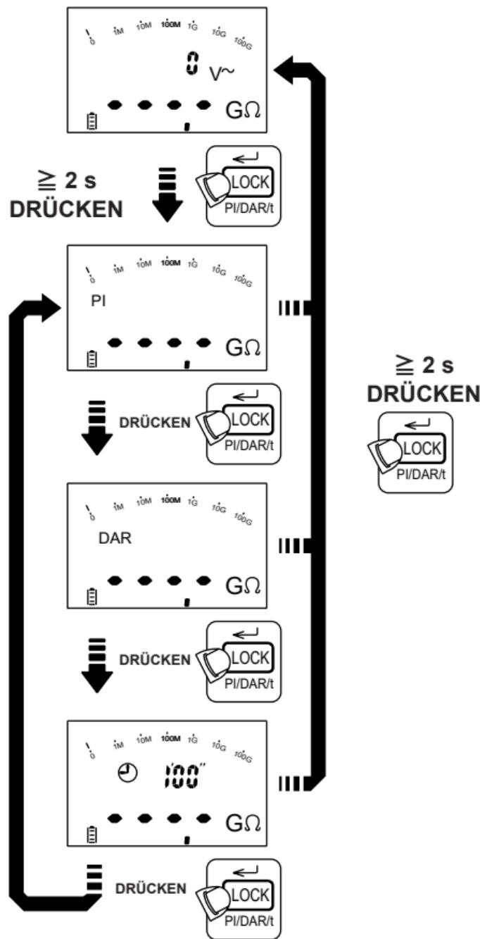
Drücken Sie die TEST-Taste, um den PI/DAR-Test zu starten/unterbrechen.
