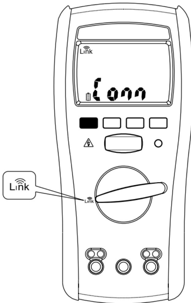
仪表使用低功率蓝牙 (BLE) V5.0 无线技术传送储存的资料。户外通讯范围最高达 6m。仪表的连结图示在成功建立连线时会在 LCD 上呈现为冻结状态。
