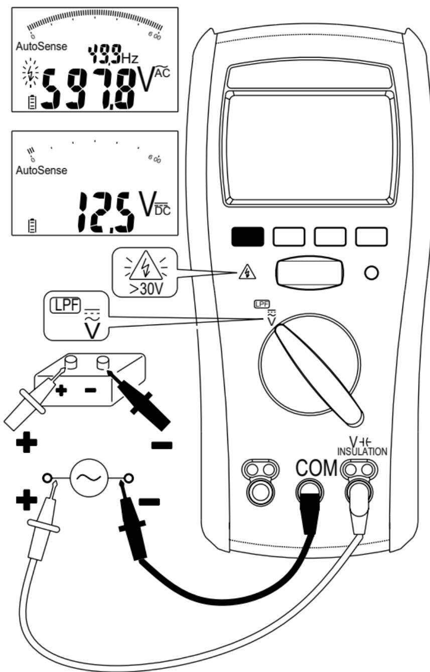
Modo de detección automática: el medidor muestra VCA o VCC, el que sea mayor ( $>1$  V).
