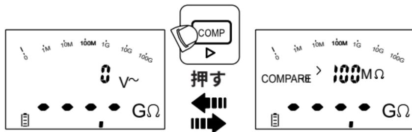
絶縁抵抗テストを開始する前に、設定モードで比較値を次の中から選択します：0.5MΩ、10MΩ、20MΩ、50MΩ、100MΩ、200MΩ、500MΩ、1000MΩ。
