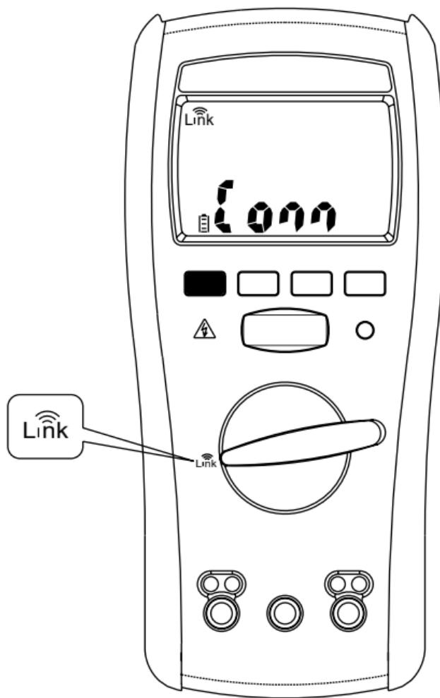
このメーターは、Bluetooth Low Energy(BLE)V5.0 ワイヤレス技術を使用して、保存されたデータをダウロードします。屋外での通信範囲は 6m までです。接続が正常に確立されると、メーターの LINK アイコンが LCD 上に表示され続けます。
