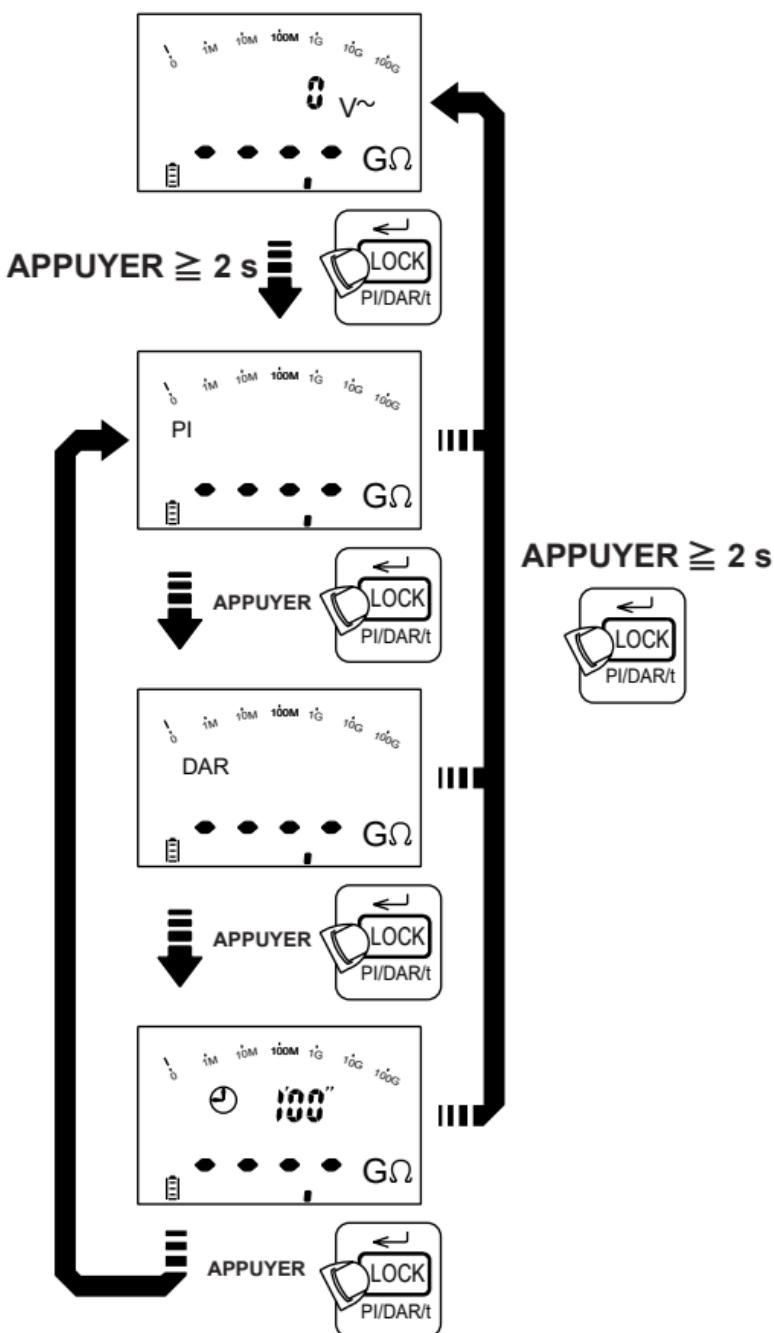
Appuyez sur le bouton TEST pour démarrer / interrompre le test PI/DAR.
