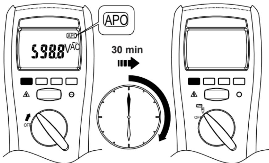
Die Stromversorgung lässt sich durch Betätigen des Drehschalters oder einer beliebigen Tasten wieder aktivieren.
