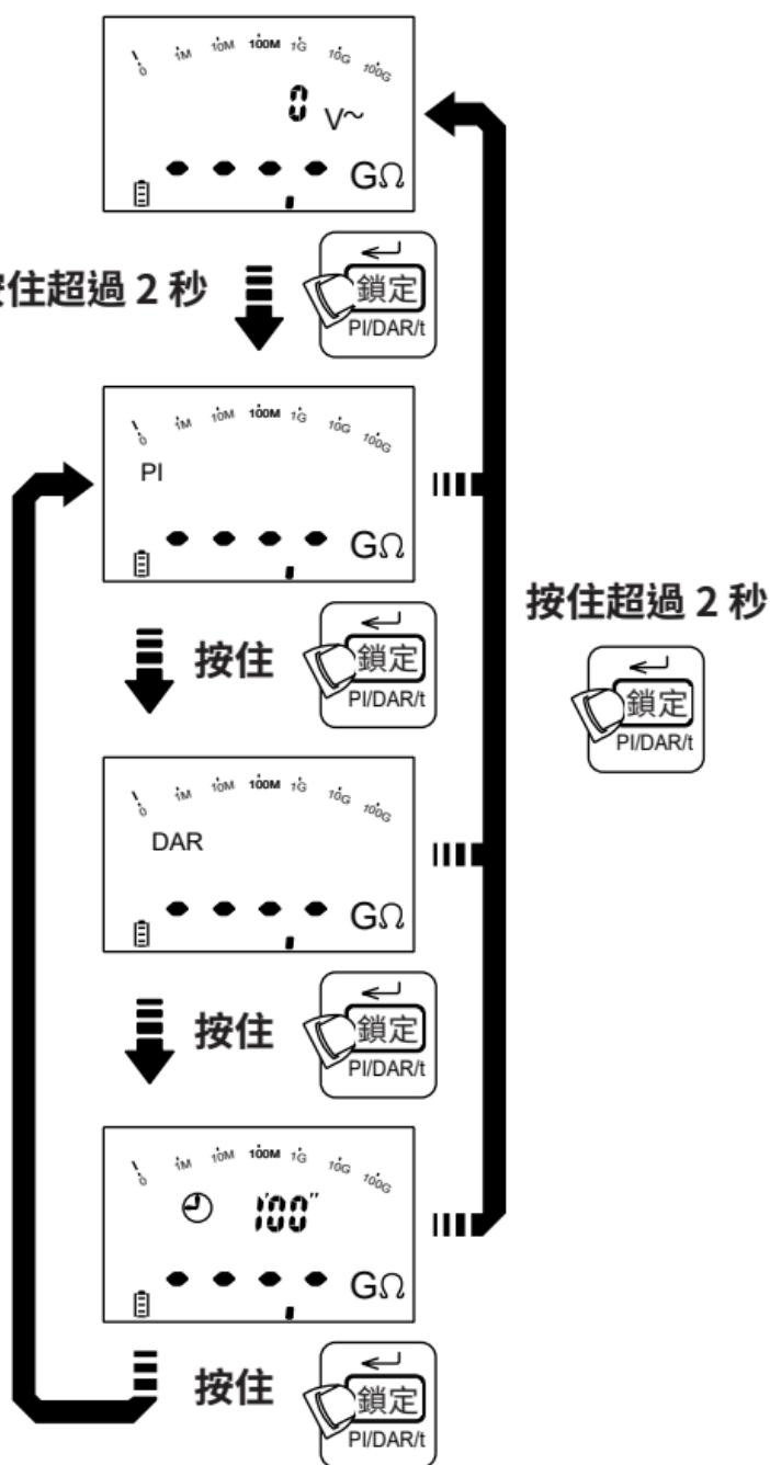
按一下測試按鈕開始／中斷 PI / DAR 測試。
