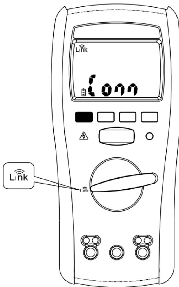
Le multimètre utilise la technologie sans fil Bluetooth low energy (BLE) V5.0 afin de télécharger les données stockées. La portée de communication à l'air libre va jusqu'à 6 m. L'icône LINK du multimètre se fige sur l'écran LCD une fois la connexion établie avec succès.
