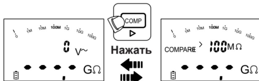
До начала проверки сопротивления изоляции выберите сравнительное значение в режиме настройки: 0,5, 10, 20, 50, 100, 200, 500, 1000 МОм.
