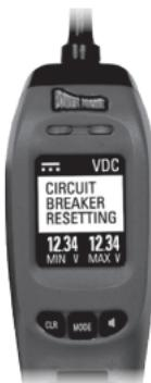
回路ブレーカーが作動すると、PPIVディスプレイに『回路ブレーカーのリセット』と表示され、数秒後に自動的にリセットされます。
