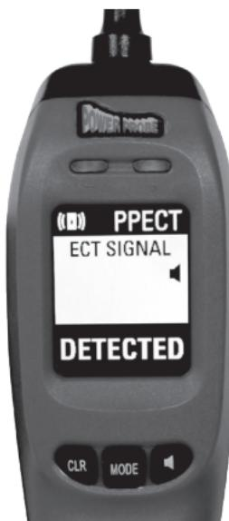
ECT 2000を使用して配線の開口部を見つける場合、ECT送信機は、通常はワイヤレスECT受信機によって受信される特殊なデジタル信号を注入します。大きな配線束やアクセスの制限など、状況によっては、ECT受信機を単独で使用する場合、ECT信号を特定し、配線障害の正確なポイントを特定することが難しい場合があります。
