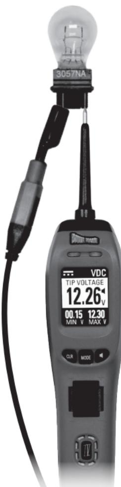
在VDC模式中启用电力组件是一个让动力探针IV在测试过程中非常实用的一个主要特征。能直接供应电池电力或接地到探针尖端，让使用者能启用并动态测试灯光、马达与螺管线之类的电力组件。
