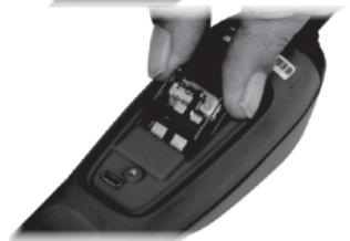
新しいサーキットブレーカーをハウジングに配置し、ブレーカースペードをブレーカー端子に合わせるように注意しながら、サーキットブレーカーがブレーカー端子に完全に噛み合うまでゆっくりと押し下げます。背面カバーと2本の固定ネジを元に戻してください。
