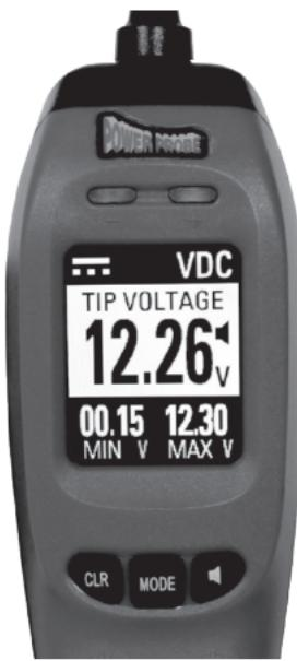
Der Power Probe IV wechselt automatisch in den VDC-Modus, wenn er zum ersten Mal an die Fahrzeughbatterie oder an eine 12-24-Volt-Stromversorgung angeschlossen wird. Der VDC-Modus ist der einzige Modus, in dem der Power Probe IV durch Drücken des Wippschalters Batteriestrom oder Masse liefern kann.
