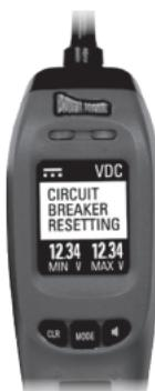
Cuando el cortacircuitos se dispara, en la pantalla de PPIV aparecerá "CIRCUIT BREAKER RESETTING" (RESTABLECIENDO EL CORTACIRCUITOS) y este se autorestablecerá después de unos segundos.
