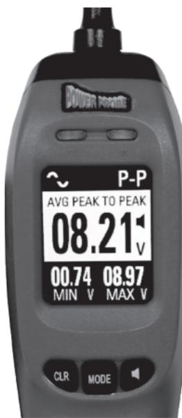
在此模式中，显示器将会是在中央出现尖端电压且于底部出现最小/最大电压读值的AC电压表。
