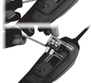
С помощью подходящего инструмента или небольшой отвертки осторожно подденьте кончик выключателя, чтобы отсоединить его. Не применяйте чрезмерную силу.
