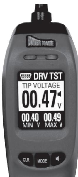
Der Treiber-Testmodus dient zum Testen der Treiber (Transistoren) im Steuerkreis des Moduls (PCM, BCM, GEM usw.)
