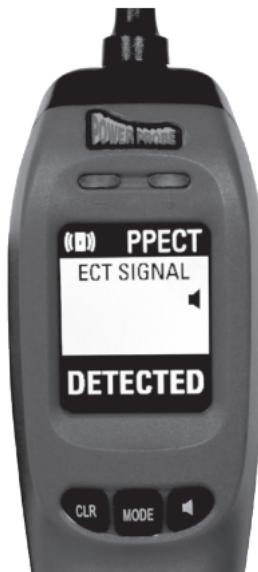
Si selecciona el Modo ECT, el Power Probe IV estará específicamente ajustado para detectar la señal de circuito abierto ECT. El Power Probe IV está concebido para funcionar en contacto directo con el circuito.
