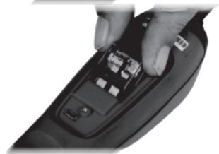
Coloque el nuevo cortacircuitos en la carcasa, ponga atención en alinear las espadas del disyuntor con los terminales del disyuntor, y presione ligeramente hacia abajo hasta que el cortacircuitos esté totalmente enganchado a los terminales del disyuntor. Reemplace la cubierta anterior y los dos tornillos de retención.
