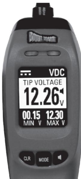
在首次連接到車輛電池或 12-24 volt 電源供應時，動力探針 IV 會自動進入VDC模式。VDC模式是唯一能以按下翹板開關而使動力探針 IV 供應電池電力或電池接地的唯一模式。
