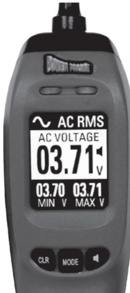
Wenn Sie die Sondenspitze mit dem Stromkreis verbinden, wird im Hauptanzeigebereich ein Ueff-gemittelter AC -Spannungsmesswert und in der unteren Zeile die RMS -Min/Max-Wechselspannungen angezeigt.
