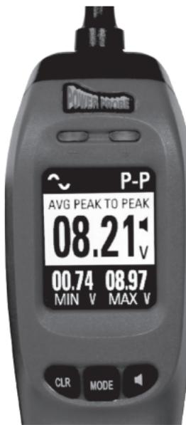
在此模式中，顯示器將會是在中央出現尖端電壓且於底部出現最小/最大電壓讀值的AC電壓表。
