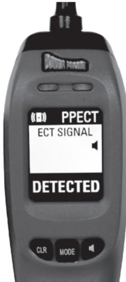
Lorsque vous utilisez l'ECT2000 pour trouver des ouvertures dans le câblage, l'émetteur ECT injecte un signal numérique spécialisé qui est normalement capté par le récepteur ECT sans fil. Dans certaines situations, telles que de gros faisceaux de câbles ou un accès limité, il peut être difficile de localiser le signal ECT et de localiser le point exact de la défaillance du câble lorsque vous utilisez le récepteur ECT seul.
