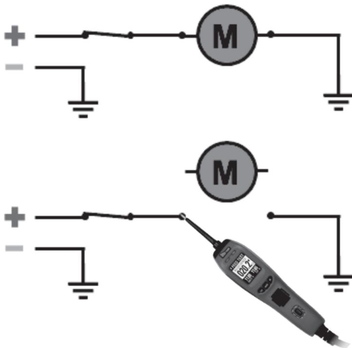
进行供电测试前，先从电路移除零件。
