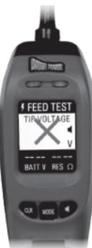
他のモードでロッカースイッチを押しても、電源やアースは適用されず、メイン画面に大きな赤い『X』が表示されます。
