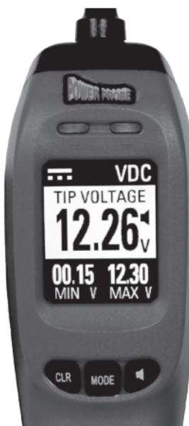
Power Probe IV автоматически переходит в режим VDC при первом подключении к аккумулятору автомобиля или к источнику питания 12-24 вольт. Режим VDC - единственный режим, в котором Power Probe IV может подавать питание от батареи или заземлять при нажатии переключателя.
