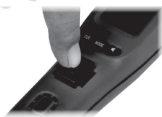
Coloque el nuevo interruptor en la cavidad y presione con cuidado hacia abajo hasta que el interruptor esté al nivel de la carcasa.
