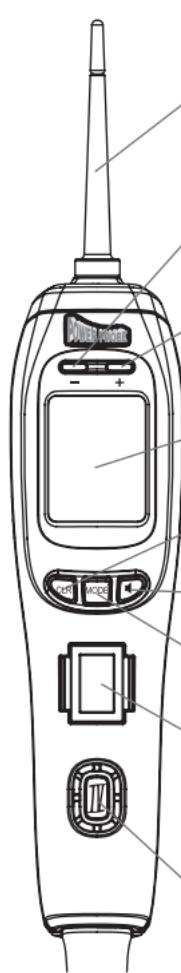
**Pointe de sonde amovible** - Utilise un connecteur de type banane standard de 4 mm permettant l'utilisation de différentes sondes, fils ou rallonges.
