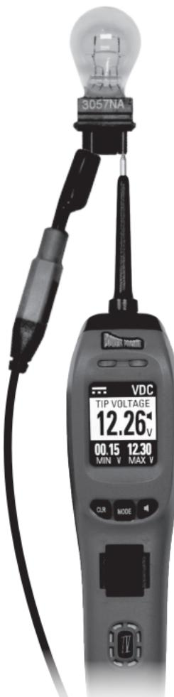
VDCモードでの電気部品のアクティブ化は、パワー プローブIVがテスト時に非常に便利である主な理由としての機能の一つです。プローブの先端(チップ)にバッテリー電源またはアースを直接供給することができるため、電気部品、モーター、およびソレノイドをアクティブにして動的にテストを実行することができます。
