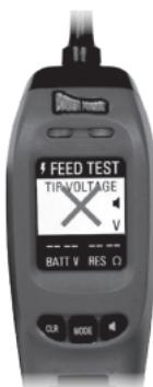
Нажатие переключателя в любом другом режиме не приведет к подаче питания или заземления, а на главном экране отобразится большой красный значок «X».
