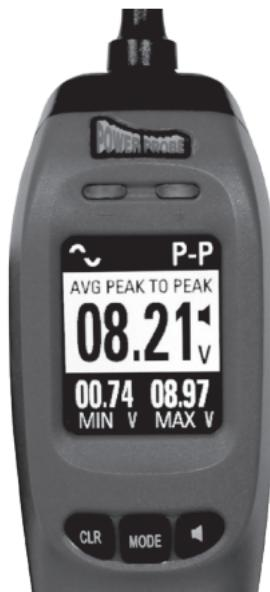
Dans ce mode, l'affichage sera un voltmètre CA qui affichera la tension de la pointe au centre et les lectures de tension Min/Max en bas de l'affichage.
