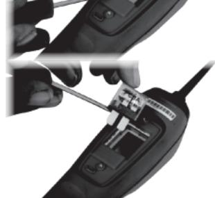
Une fois que le disjoncteur est détaché des bornes, soulevez délicatement le disjoncteur de la cavité du boîtier.
