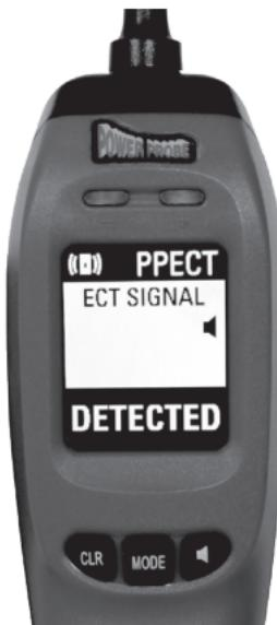
Wenn Sie den ECT-Modus wählen, ist der Power Probe IV jetzt speziell auf die Erkennung des ECT-Unterbrechungssignals abgestimmt. Der Power Probe IV ist dazu gedacht, durch direkten Kontakt mit dem Stromkreis zu funktionieren.
