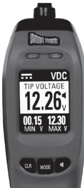
在首次连接到车辆电池或 12-24 volt 电源供应时, 动力探针 IV 会自动进入 VDC 模式。VDC 模式是唯一能以按下翘板开关而使动力探针 IV 供应电池电力或电池接地的唯一模式。
