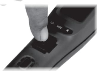
Retirez délicatement l'interrupteur à bascule avec un outil de levier approprié ou un petit tournevis. N'appliquez pas de force
