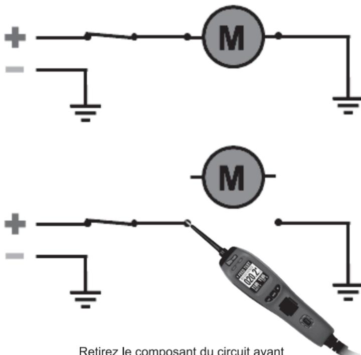
Retirez le composant du circuit avant d'effectuer le test d'alimentation
