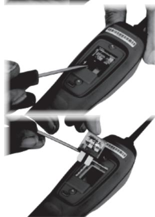
使用適當的翹具或小螺絲起子，小心地將電路斷路器朝尖端方向翹起，然後將其從斷路器端子解開。不要施加多餘的力量。
