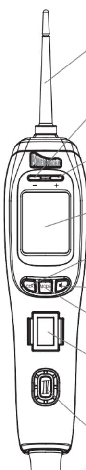
**1 可移除探針尖端** - 使用標準的4mm香蕉狀接頭,以便用於不同的探針、導線或延伸。
