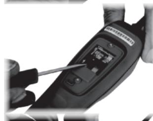
使用适当的翘具或小螺丝起子,小心地将电路断路器朝尖端方向翘起,然后将其从断路器端子解开。不要施加多余的力量。
