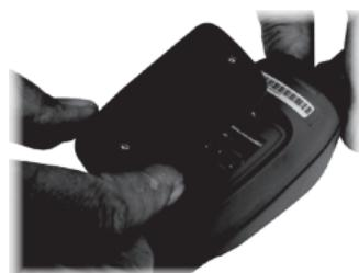
Desatornille los dos tornillos de retención y extraiga la cubierta posterior.
