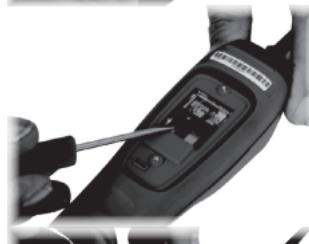
Heben Sie den Schutzschalter mit einem geeigneten Hebelwerkzeug oder einem kleinen Schraubendreher vorsichtig in Richtung der Spitze, um ihn von den Klemmen des Unterbrechers zu lösen. Wenden Sie keine übermäßige Kraft an.
