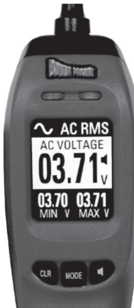
プローブチップを回路に接触させると、メイン表示領域にRMS平均AC電圧の読み取り値が表示され、ボトムラインにRMS最小/最大AC電圧も表示されます。
