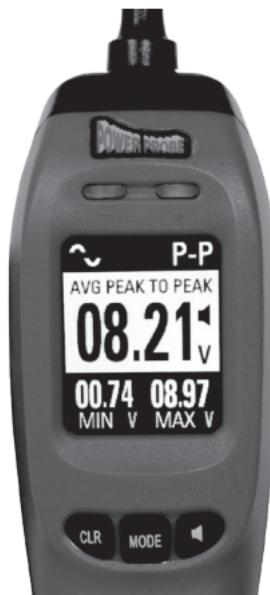
このモードでは、ディスプレイがAC電圧計になり、中央にチップ電圧が表示され、ディスプレイの下部に最小/最大電圧の読み取り値が表示されます。
