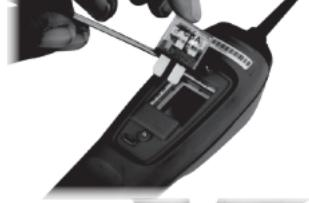
Sobald sich der Schutzschalter von den Anschläßen gelöst hat, heben Sie den Schalter vorsichtig aus dem Gehäusehohlraum.
