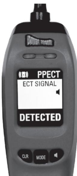
当使用ECT2000找出线路中的开路时，ECT发射机会发射出通常只会被无线ECT接收器接收的特殊数位信号。在某些情况下，例如大线束或受限使用，要确定ECT信号与找出正确的线路故障点，在单独使用ECT接收器的情况下会是很困难的。
