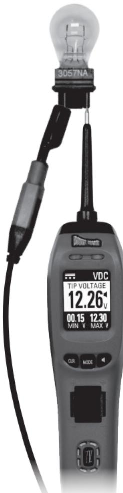
Активация электрических компонентов в режиме постоянного тока - одна из функций, которые делают Power Probe IV очень полезным при тестировании. Возможность подачи питания от батареи или заземления прямо на наконечник зонда дает вам возможность активировать и динамически тестировать электрические компоненты, такие как фонари, двигатели и соленоиды.
