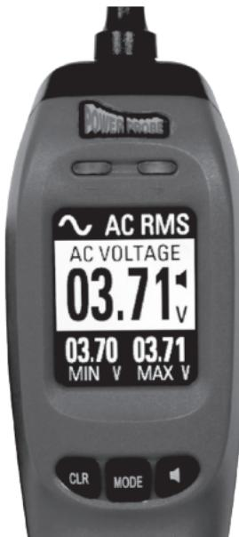
以探針尖端接觸電路，主要顯示區域會顯示RMS平均AC電壓讀值，也會在底行顯示RMS最小/最大AC電壓。
