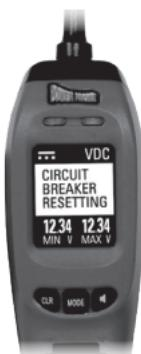
Когда автоматический выключатель срабатывает, на дисплее PPIV отображается «CIRCUIT BREAKER RESETTING», и он автоматически сбрасывается через несколько секунд.
