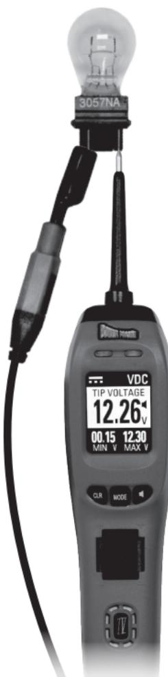
在VDC模式中啟用電力組件是一個讓動力探針IV在測試過程中非常實用的一個主要特徵。能直接供應電池電力或接地到探針尖端，讓使用者能啟用並動態測試燈光、馬達與螺管線之類的電力組件。
