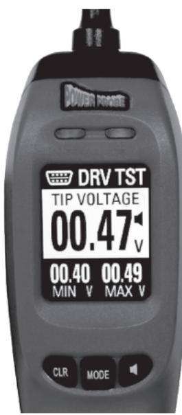
越來越多現代車輛的電器零件，都以電腦模組或電子控制單元(ECUs)開啟或關閉。許多零件，像是變速器螺線管或燃油噴射器，都可以直接從ECU切換。其他像散熱器風扇之類的高電流零件，都經由可由ECU控制的繼電器操作。特殊的電晶體電路，也稱為驅動器電路，則內建於這些可供應必要的電流而為不同部件供電的模組中。
