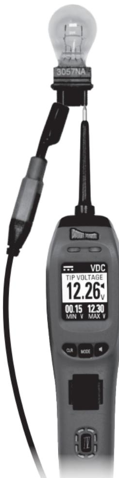
La activación de los componentes eléctricos en Modo VDC es una de las funciones principales que hacen que el Power Probe IV sea muy útil para realizar las pruebas. La capacidad de aplicar alimentación de batería o masa directamente a la punta del sensor le permite activar y probar de manera dinámica componentes eléctricos como luces, motores y solenoides.
