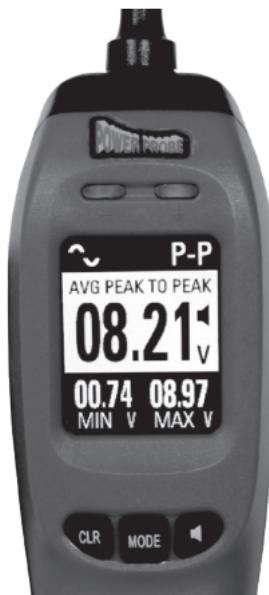
En este modo, lo que aparece en pantalla será un voltímetro de AC que muestra el voltaje de la punta en el centro y las lecturas del voltaje Min/Máx a lo largo de la parte inferior de la pantalla.
