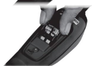
将新的电路断路器定位到外壳,小心地将断路器的铲形物对齐断路器端子,并轻轻地将其下压,直到电路断路器完全与断路器端子接合。
