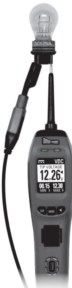
L'activation des composants électriques en mode VDC est l'une des principales caractéristiques qui rendent le Power Probe IV très utile lors des tests. Pouvoir appliquer l'alimentation de la batterie ou la terre directement à la pointe de la sonde vous donne la possibilité d'activer et de tester dynamiquement les composants électriques tels que les lumières, les moteurs et les solénoïdes.
