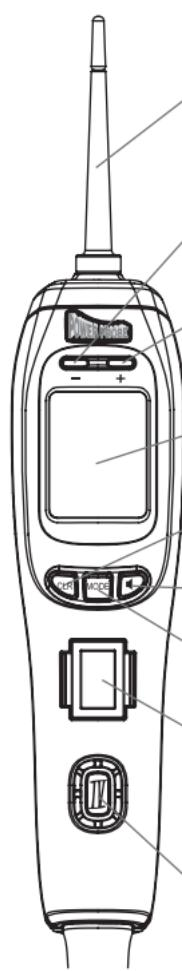
**Punta removible del sensor** - Usa un conector estándar tipo banana de 4mm que permite el uso de diferentes sensores, cables o extensiones.
