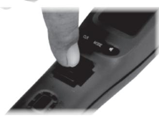
適切なこじりツールまたは小さなドライバーを使ってロックケースイッチを取り外してください。過度な力を加えないでください。
