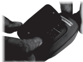
Lösen Sie die beiden Befestigungsschrauben und entfernen Sie die hintere Abdeckung.
