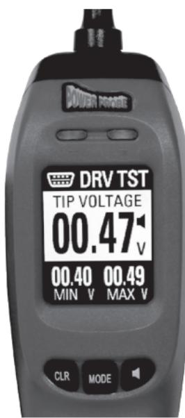
越来越多现代车辆的电器零件,都以电脑模组或电子控制单元(ECUs)开启或关闭。许多零件,像是变速器螺线管或燃油喷射器,都可以直接从ECU切换。其他像散热器风扇之类的高电流零件,都经由可由ECU控制的继电器操作。特殊的电晶体电路,也称为驱动器电路,则内建于这些可供应必要的电流而为不同部件供电的模组中。
