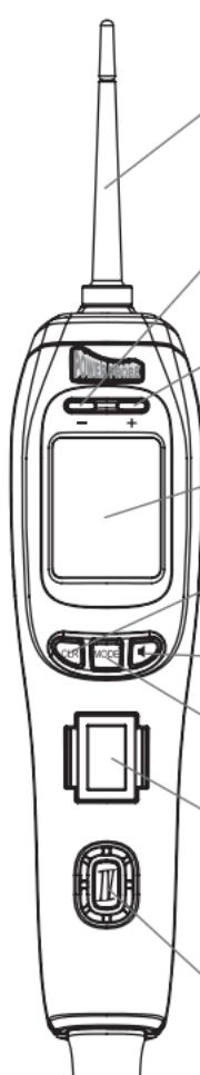
**1 可移除探针尖端** - 使用标准的4mm香蕉状接头,以便用于不同的探针、导线或延伸。
