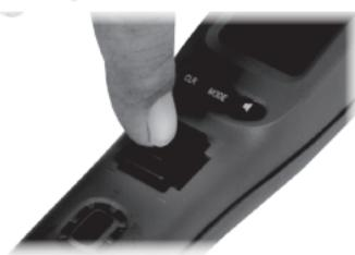
Entfernen Sie den Wippschalter vorsichtig mit einem geeigneten Hebelwerkzeug oder einem kleinen Schraubendreher. Wenden Sie keine übermäßige Kraft an.
