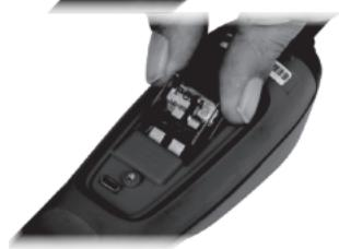
一旦電路斷路器從端子鬆開，小心地將斷路器從外殼孔中移出。
