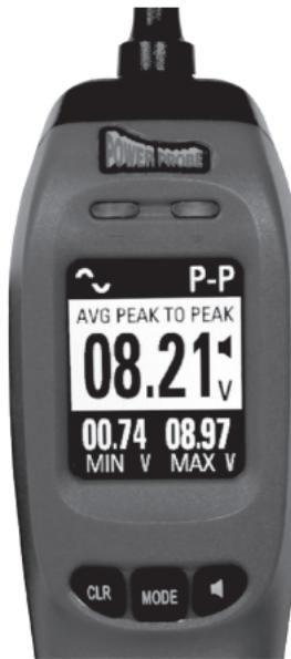
In diesem Modus ist das Display ein AC Voltmeter, der die Spitzenspannung in der Mitte und die Min-/Max -Spannungswerte am unteren Rand des Displays anzeigt.
