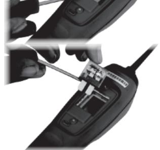
サーキットブレーカーが端子から緩んだら、ブレーカーをハウジングの空洞から慎重に持ち上げてください。
