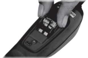
Setzen Sie den neuen Schutzschalter in das Gehäuse ein, achten Sie darauf, dass die Unterbrecherspaten mit den Unterbrecherklemmen übereinstimmen, und drücken Sie ihn vorsichtig nach unten, bis er vollständig in den Unterbrecherklemmen eingerastet ist. Bringen Sie die hintere Abdeckung und die beiden Befestigungsschrauben wieder an.
