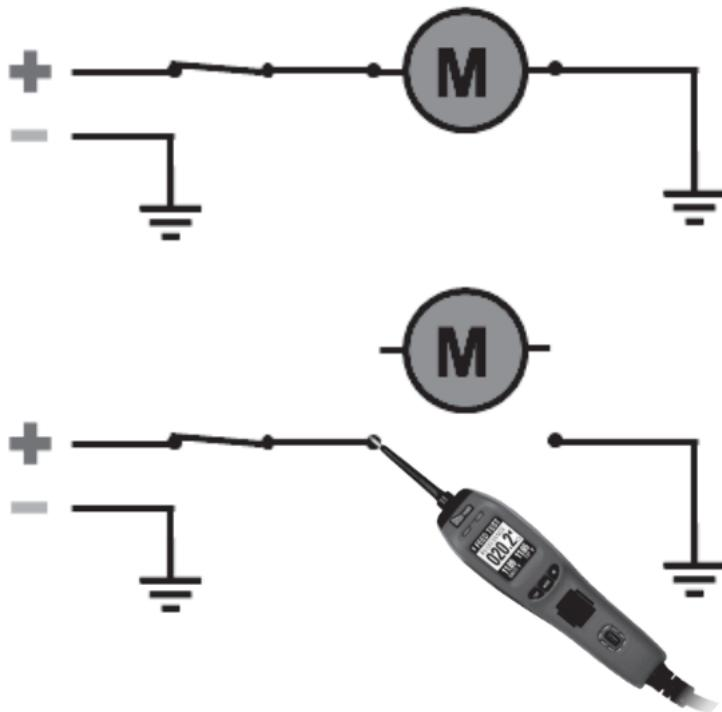
進行供電測試前，先從電路移除零件。
