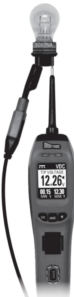
Die Aktivierung elektrischer Komponenten im VDC-Modus ist eine der Hauptfunktionen, die den Power Probe IV bei Prüfungen sehr nützlich machen. Durch die Möglichkeit, Batteriespannung oder Masse direkt an die Sondenspitze anzulegen, können Sie elektrische Komponenten wie Leuchten, Motoren und Magnetspulen aktivieren und dynamisch prüfen.
