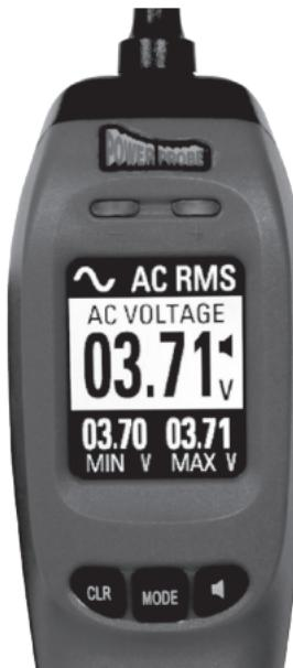
Cuando la punta del sensor hace contacto con el circuito, aparecerá una lectura RMS de voltaje de AC promedio en el área principal de la pantalla, y al mismo tiempo presentará voltajes RMS Min/Máx AC en la línea inferior.
