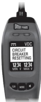
Wenn der Schutzschalter ausgelöst wird, zeigt das PPIV-Display „CIRCUIT BREAKER RESETTING“ an und stellt sich nach einigen Sekunden automatisch zurück.
