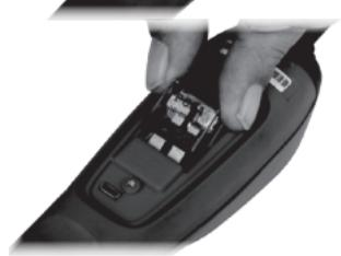
Поместите новый выключатель в корпус, выровняйте его и осторожно давите, пока выключатель полностью не зафиксируется в гнезде. Установите на место крышку и два крепежных винта.
