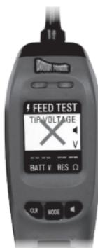
Le fait d'appuyer sur l'interrupteur à bascule dans un autre mode n'appliquera pas d'alimentation ou de masse et l'écran principal affichera un grand " X " rouge.
