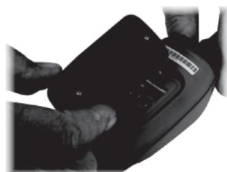
Dévissez les deux vis de fixation et retirez le couvercle arrière.
