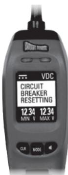
當電路斷路器跳脫時，PPIV顯示器會出現“電路斷路器重設”且會於幾秒鐘後自動重設。
