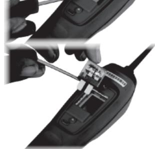
Una vez que el cortacircuitos se haya soltado de los terminales, levante con cuidado el disyuntor de la cavidad de su carcasa.
