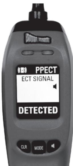
當使用ECT2000找出線路中的開路時，ECT發射機會發射出通常只會被無線ECT接收器接收的特殊數位信號。在某些情況下，例如大線束或受限使用，要確定ECT信號與找出正確的線路故障點，在單獨使用ECT接收器的情況下會是很困難的。
